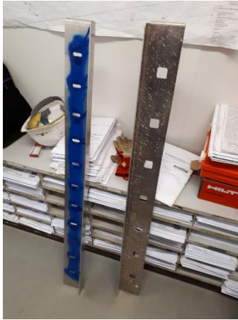
Abbildung 54: Baustelle BO - Bohrschablone für Kernbohrungen im Bereich der Hohlkammern, [ACMS Architekten GmbH], 28.03.2018
