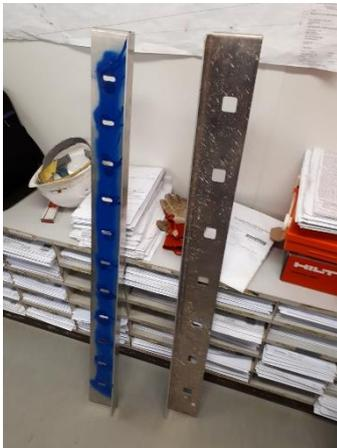
Abbildung 54: Bohrschablone für Kernbohrungen im Bereich der Hohlkammern, [ACMS Architekten GmbH], 28.03.2018
