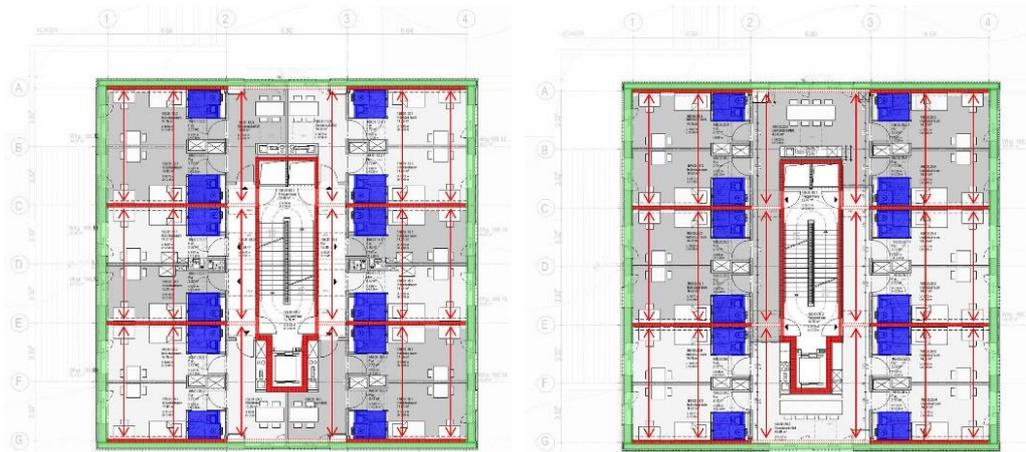
Abbildung 6: 1.-2.OG, System Vorfertigung, [ACMS Architekten GmbH]
