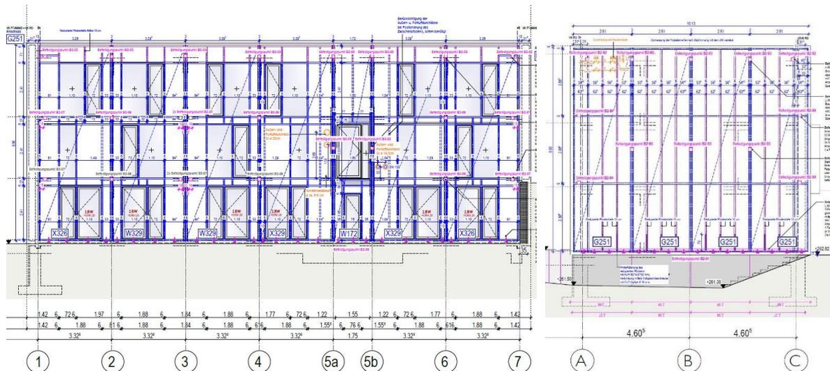
Abbildung 101: Positionsplan Holzbau Ansicht Süd-West Haus 166, [ACMS Architekten GmbH]
