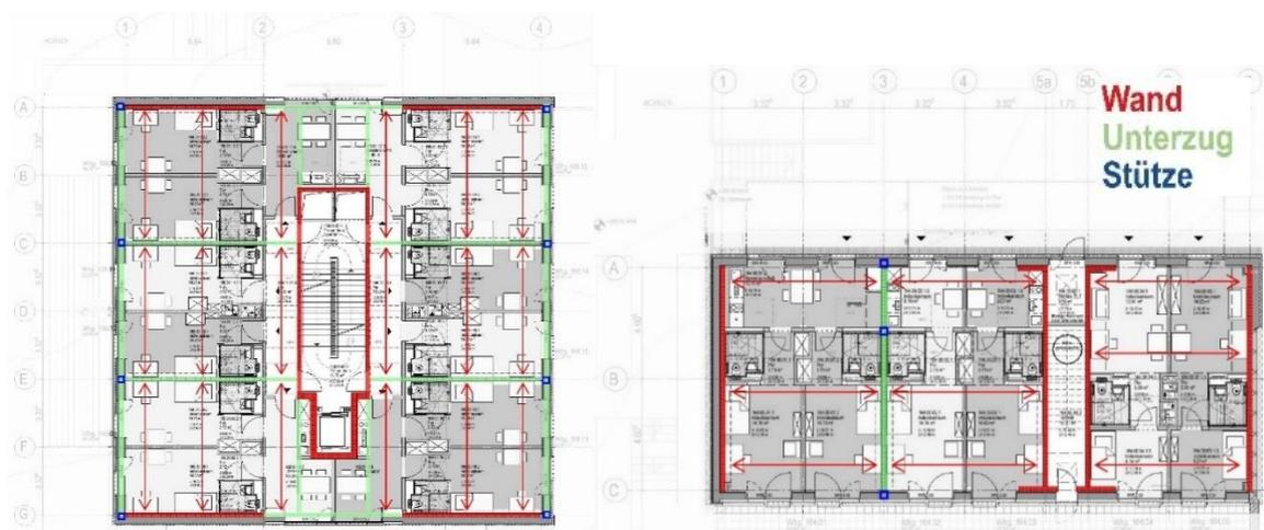
Abbildung 42: Skizze Tragwerkkonzept, 1. Variante - auf Grundlage von TSB Ingenieurgesellschaft mbH - Deckenspannrichtung parallel zur Hauptfassade, Haus 168 und 164 [ACMS Architekten GmbH]
