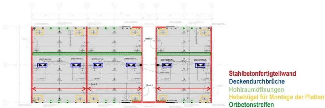
Abbildung 31: Montageplanung der Spannbeton-Hohlplatten Haus 2-5 - Decke über EG von Haus 5, [DW Systembau GmbH]
