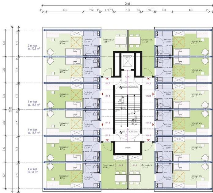
Abbildung 71: Grundrissvariante Haus 168 2.OG und 1. OG, [ACMS Architekten GmbH]
