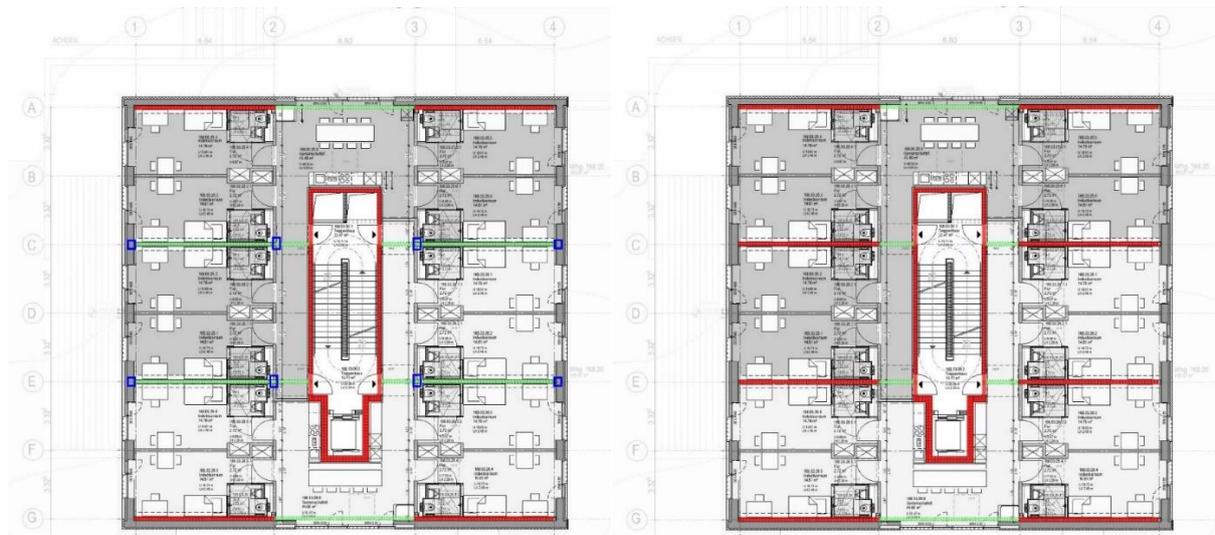
Abbildung 47: Rohbaukonstruktion mit Stützen / Verbundträgern Haus 168 4.OG, [ACMS Architekten GmbH]
