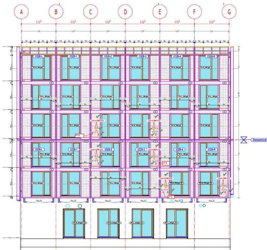
Abbildung 131: Positionsplan der Fassadenelemente Haus 168 Ansicht Nord-West, [Zimmerei Sieveke GmbH]
