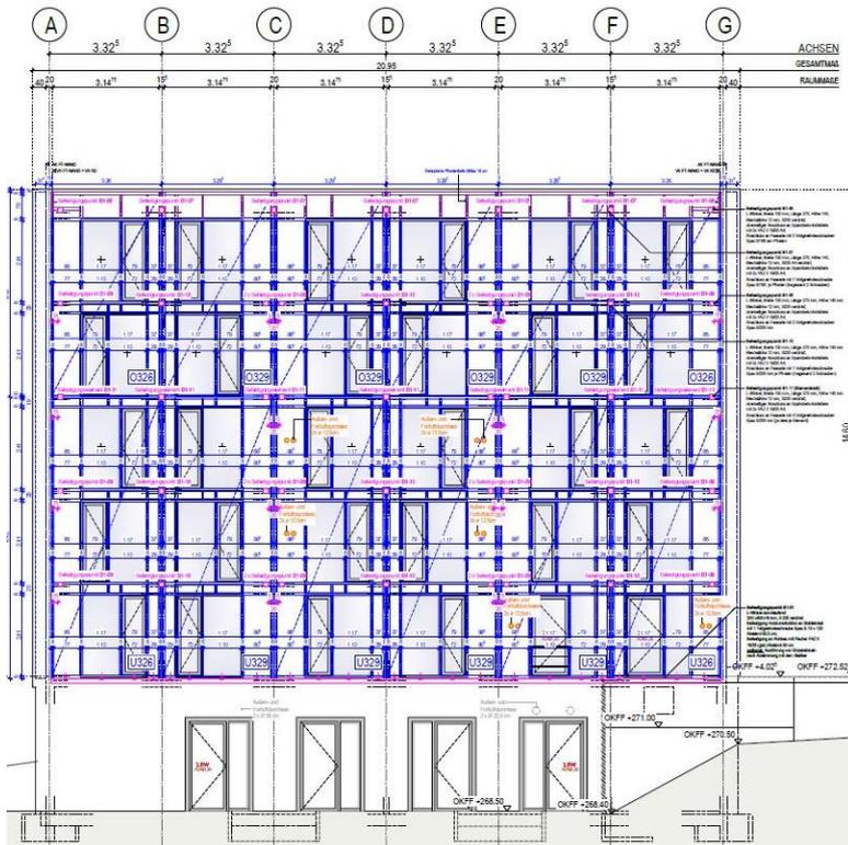
Abbildung 105: Positionsplan Holzbau Haus 168 Ansicht Nord-West, [ACMS Architekten GmbH]
