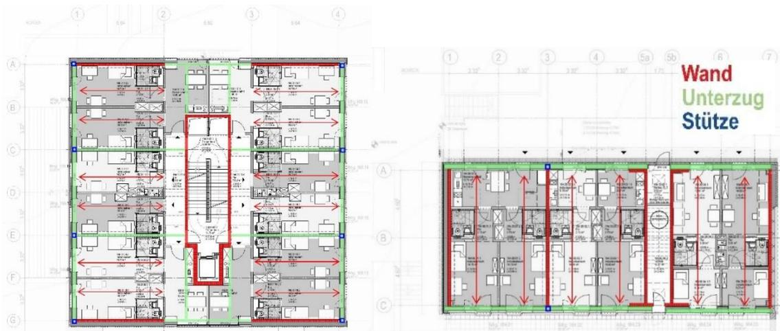
Abbildung 43: Skizze Tragwerkkonzept, 2. Variante - auf Grundlage von TSB Ingenieurgesellschaft mbH - Deckenspannrichtung quer zur Hauptfassade, Haus 168 und Haus 164 [ACMS Architekten GmbH]
