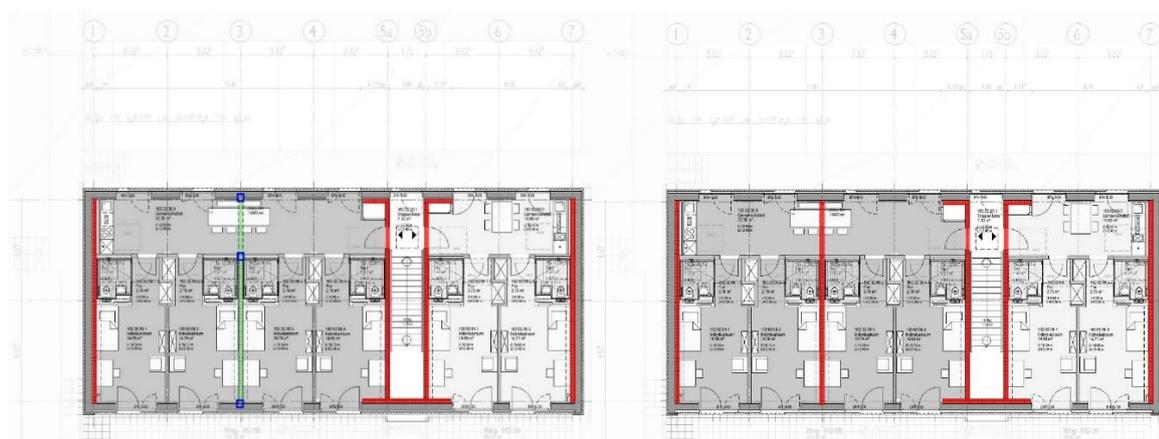
Abbildung 49: Rohbaukonstruktion mit Stützen / Verbundträgern Haus 162 2.OG, [ACMS Architekten GmbH]
