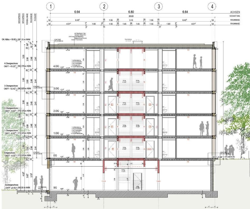
Abbildung 227: Haus 168 Schnitt B-B M 1:250, [ACMS Architekten GmbH]
