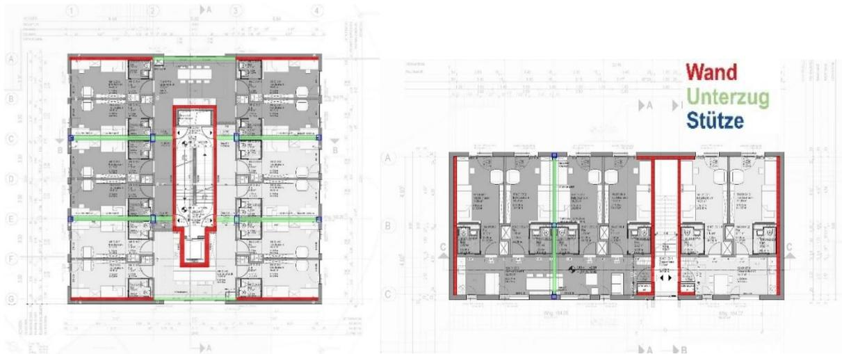
Abbildung 44: Planungsstand April 2017 Haus 168 3. OG und 164 1. OG (Ausführungsplanung)- auf Grundlage von TSB Ingenieuresellschaft mbH- Rohbaukonstruktion mit Stützen / Verbundträgern, [ACMS Architekten GmbH]
