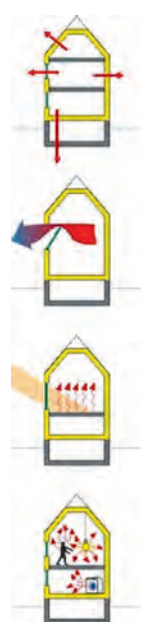
(17) Die Regulierung des Wärmehaushalts eines Gebäudes stellt ein komplexes System von Parametern dar. Die Lüftungsverluste werden durch den Einsatz der zentralen Lüftungsanlage wesentlich reduziert.
